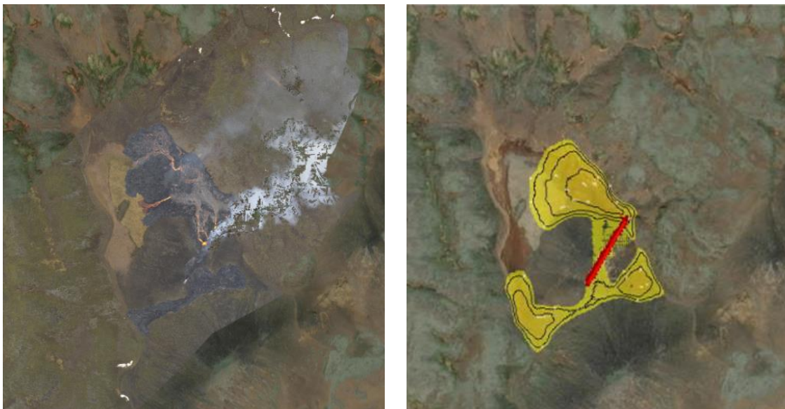
Mynd 2 Til vinstri: Hraunútbreiðsla 20. mars 2021 (vefur LMÍ). Til hægri: Hermd hraunútbreiðsla, seigja 10000 Pa s, flotspenna 2000 Pa, hraunflæði úr sprungu 5 \text{ m}^3/\text{s} frá upphafi goss til kl. 12:00 þann 21. mars
